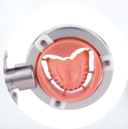
Fig. 4 Base definitiva fresata in PMMA, dopo prova in cera eseguita con successo.
