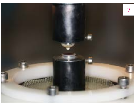
Abb. 2 Il test di abrasione Pin-on-Block (POB) è stato eseguito con una sfera in steatite su otto diversi provini di ogni prodotto.
