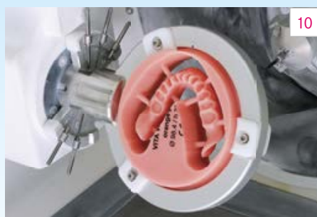
Fig. 10 La base della protesi è stata fresata da un disco PMMA VITA VIONIC BASE.
