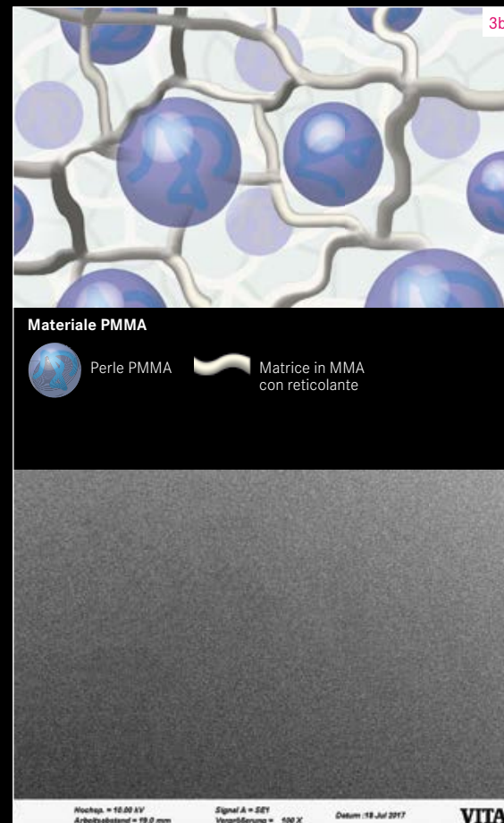
Fig. 3a/b Raffronto tra composito MRP (sinistra) e PMMA (destra) con rappresentazioni schematiche della struttura merceologica e fotografie al microscopio elettronico a scansione (SEM).
